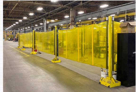
ROLLTect Utiliza una base de rodillos tensada para mantener la barrera firmemente tensa al extenderse por el área de trabajo. El operador simplemente jala la pantalla del rodillo de montaje en la base hasta los ganchos en el lado opuesto de la celda de trabajo. Al introducir o extraer un producto de la celda de trabajo, el operador desengancha fácilmente la pantalla y la guía de regreso a la base de rodillos.
