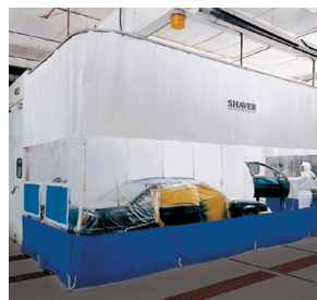
CABINAS DE PINTURA
