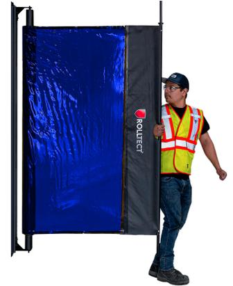
ROLLTect Utiliza una base de rodillos tensada para mantener la barrera firmemente tensa al extenderse por el área de trabajo. El operador simplemente jala la pantalla del rodillo de montaje en la base hasta los ganchos en el lado opuesto de la celda de trabajo. Al introducir o extraer un producto de la celda de trabajo, el operador desengancha fácilmente la pantalla y la guía de regreso a la base de rodillos.
