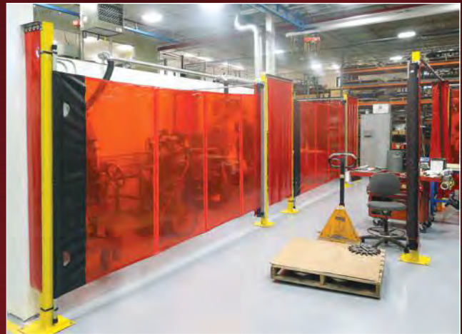
CORTINA DE SOLDADURA RETRÁCTIL CON POSTES FIJOS Y HAWAIANA DE PVC EN LA ENTRADA
