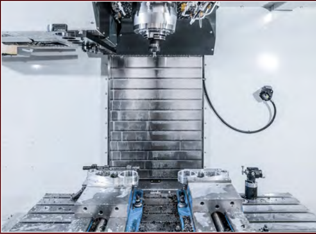
CUBIERTAS PARA VIAS DE TELA CON REVESTIMIENTO DE ACERO
