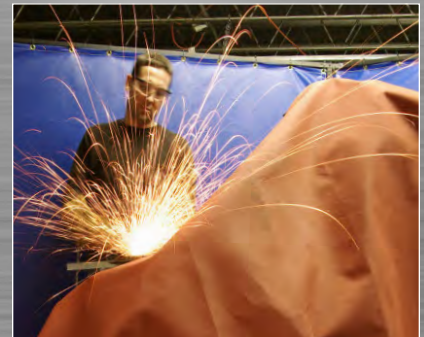
MANTAS PARA SOLDADURA
