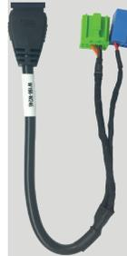
Este cabo é usado para conectar a caixas EZS/EIS durante as aplicações de programação de chaves Mercedes Benz W166-W246
