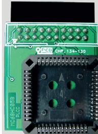
Este adaptador é usado para ler alguns MCUs de 52 pinos localizados nas PCBs da caixa do imobilizador. O MCU deve ser removido da PCB da caixa do imobilizador ao usar este adaptador. O ZFH-EA5 também pode ser usado em vez deste adaptador.
