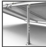
El poste **1035** puede ser tan alto se requiera, se fija a la superficie con otro ángulo. Se Puede ajustar la altura.
