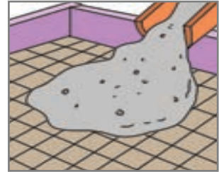
콘크리트를 타설하다 to place concrete
