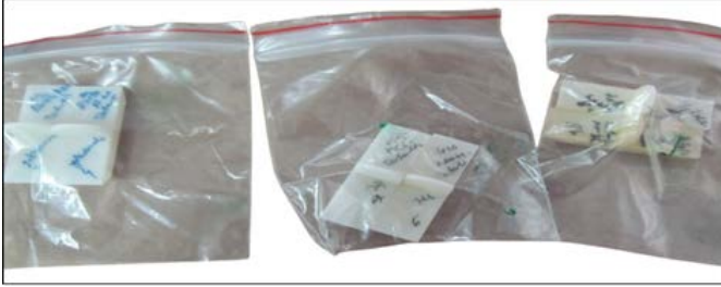
Şekil 3. Deneyisel süreçte aşındırma için kullanılan ABS numune örnekleri
