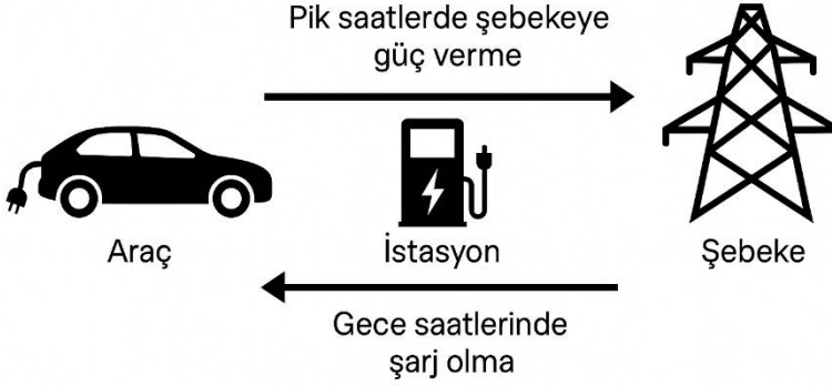
Şekil 2. V2G (Vehicle-to-Grid) senaryosunda elektrikli aracın, şarj istasyonu aracılığıyla şebekeye pik saatlerde enerji sağlaması ve gece saatlerinde şebekeden enerji alarak şarj olması sürecini gösteren akış diyagramı
