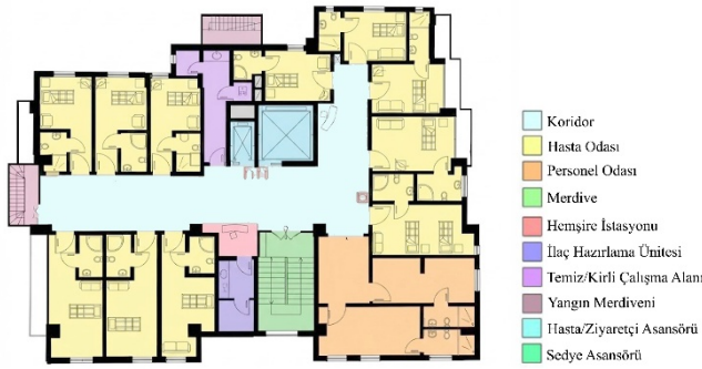
Şekil 7. H4 Hasta Odası Kat Planı ve Mekânsal Organizasyonu
