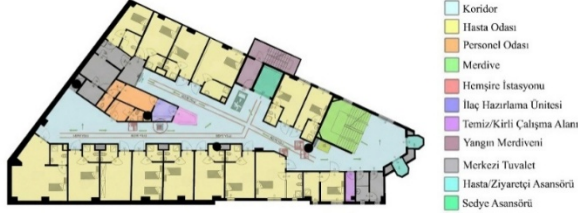
Şekil 3. H2 Hasta Odası Kat Planı ve Mekânsal Organizasyonu
