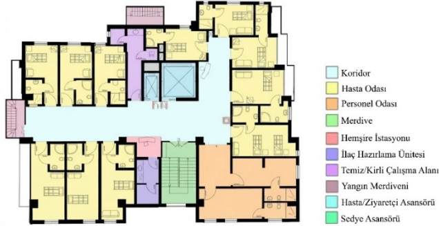
Şekil 5. H3 Hasta Odası Kat Planı ve Mekânsal Organizasyonu
