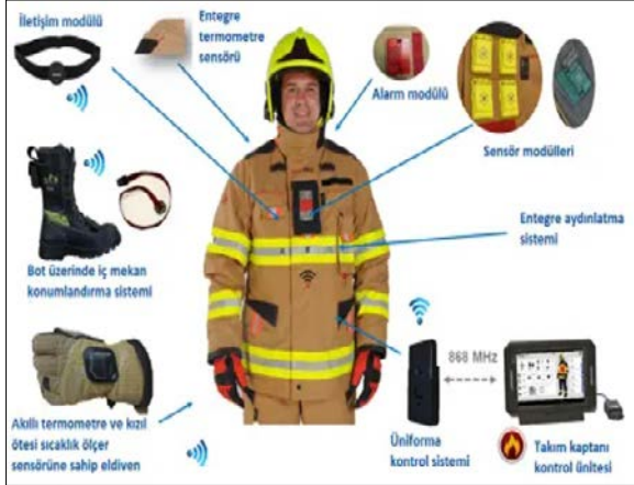
Görsel 7. İtfaiyeci Üniformasında Kullanılan Akıllı Tekstiller
