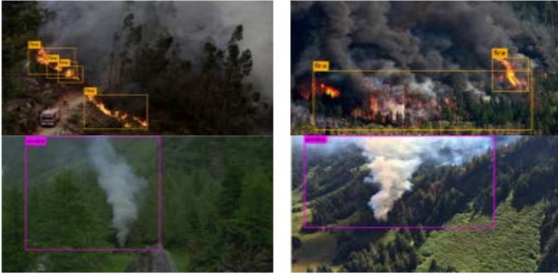
Şekil 5. İHA ile elde edilen görüntüler üzerinde YOLOv3 derin öğrenme algoritmaları kullanılarak yangın bölgesi tespit edilmesi (Jiao vd., 2019)
