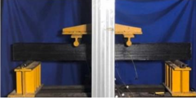
Şekil 4. 4 noktalı eğilme test düzeneği (Li ve ark. 2025)
