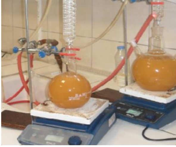
Şekil 4. Farklı sıcaklık koşullarında gerçekleştirilen transesterifikasyon reaksiyonu
