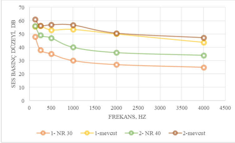
Şekil 7. PencereLER açık durumdayken ses basınç düzeyi karşılaştırması
