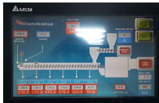
Şekil 2. PP Kompozitinin Ekstrüder Üretim Sıcaklıkları
