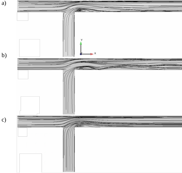
Şekil 4. 90° nehir birleşimi için üç farklı türbülans modeli kullanılarak elde edilen akım çizgilerinin plan görünüşü: a) standart k-\epsilon , b) k-\omega ve c) RNG k-\epsilon .
