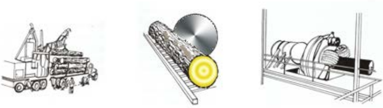
Şekil 4. Ağaçların kesilmesi ve kabuklarının soyulması
