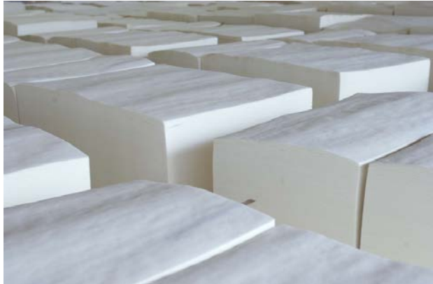
Şekil 7. Selülozun kuru levhalar hâlinde depolanması
