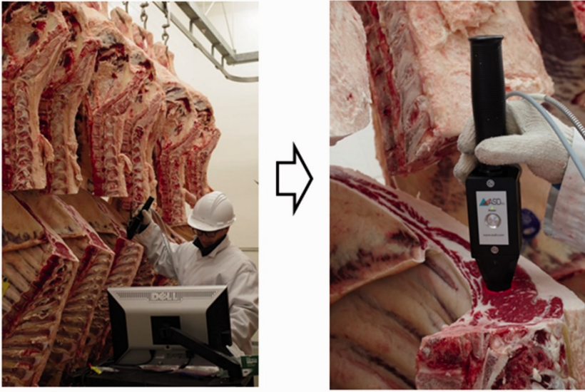
Şekil 3. Taşınabilir bir cihaz kullanılarak sığır antrikotundan gerçek zamanlı olarak yakın kızılötesi (NIR) spektrumlarının toplanması. Kaynak: Kanada Tarım ve Gıda Bakanlığı – Lacombe (Prieto et al., 2017).
