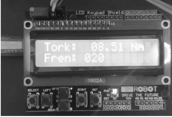
Resim 1. Oluşturulan Devrenin LCD Ekran Görüntüsü
