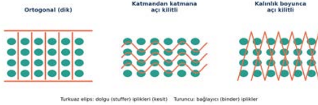
Şekil 1. Başlıca 3B dokuma mimarilerinin çözgü doğrultusundaki kesit şemaları. Yazar tarafından özgün olarak çizilmiştir; ölçekli değildir.
