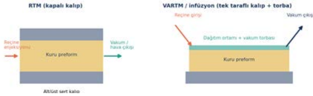
Şekil 2. RTM ve VARTM/infüzyon süreçlerinin şematik gösterimi. Yazar tarafından özgün olarak çizilmiştir.
