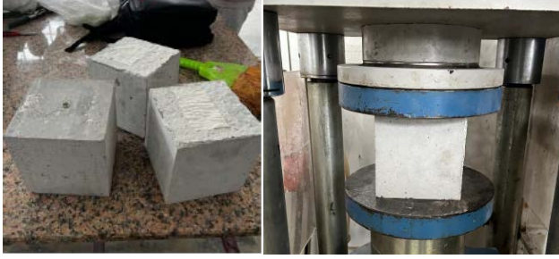
Şekil 4. Beton basınç numuneleri ve deneyin yapılışı
