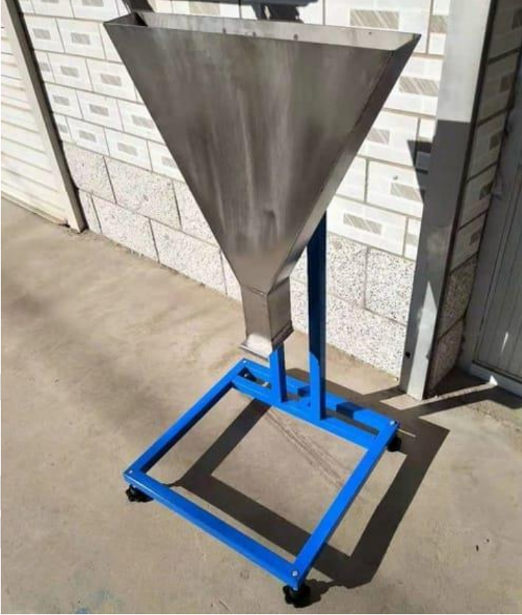
Şekil 2. V hunisi deney düzeneği
