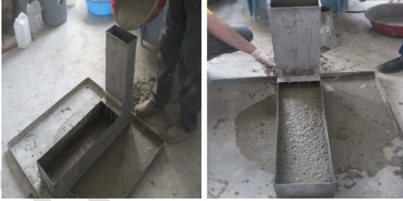
Şekil 4. L kutusu deney düzeneği
