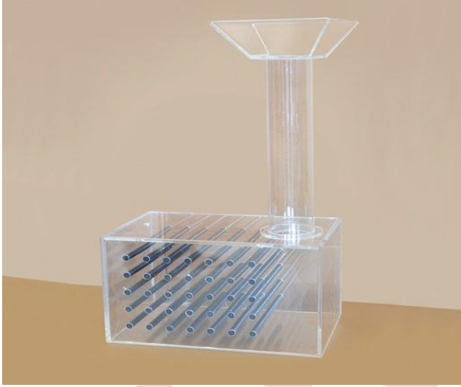
Şekil 5. Doldurma kutusu deney düzeneği
