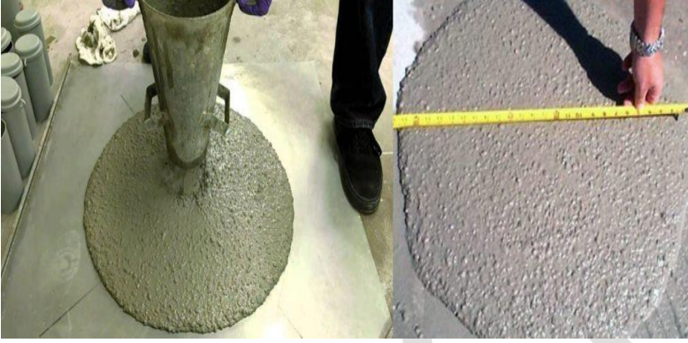
Şekil 1. Çökme ve yayılma deney yapımı
