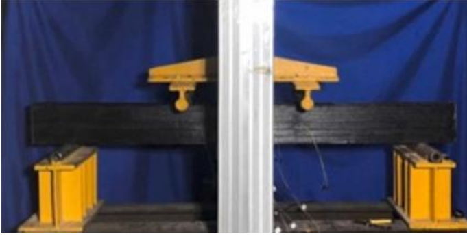
Şekil 4. 4 noktalı eğilme test düzeneği (Li ve ark. 2025)
