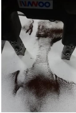
Şekil 5. Manyetik yoke ayakları arasına serpişen manyetik paracakların manyetik alan çizgileri üzerinde yönlenmeleri
