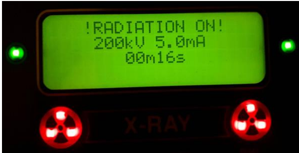
Şekil 11. Xray cihazında 200Kv 5mA dğerinde 16 saniye olarak yapılan pozlamanın kontrol ekranında görüntüsü.
