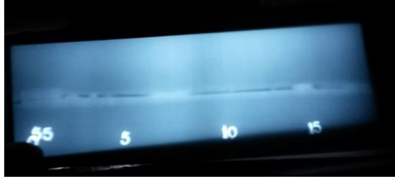
Şekil 12. Kaynakta bulunan kökte nüfuziyetsizlik hatasının radyograf üzerinde görüntüsü.
