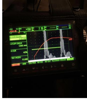
Şekil 9. Disk şekilli yansıtıcı referans alınarak çizilmiş olan DGS eğrisine göre çelik sac üzerinde laminasyon ve segregasyon kontrolü.
