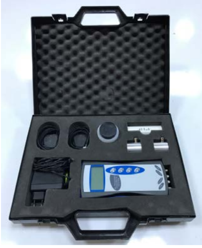
Şekil 3.11.UPV cihazı test cihazı ve düzeneği.
