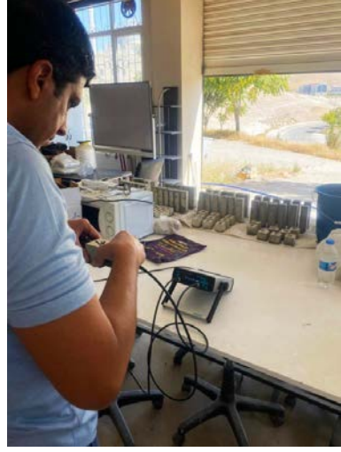
Şekil 3.11.UPV cihazı test cihazı ve düzeneği.
