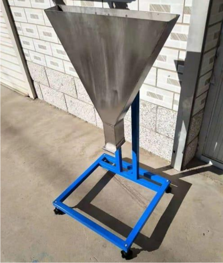
Şekil 2. V hunisi deney düzeneği
