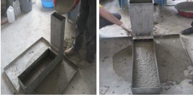
Şekil 4. L kutusu deney düzenegi
