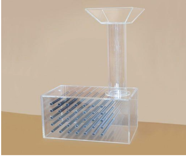
Şekil 5. Doldurma kutusu deney düzeneği
