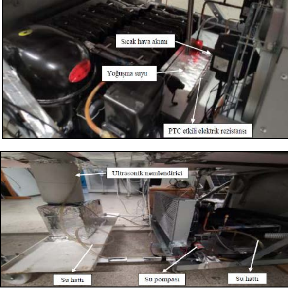
Şekil 9. TTS için geliştirilen su yönetimi yaklaşımları (Şensoy vd., 2025)
