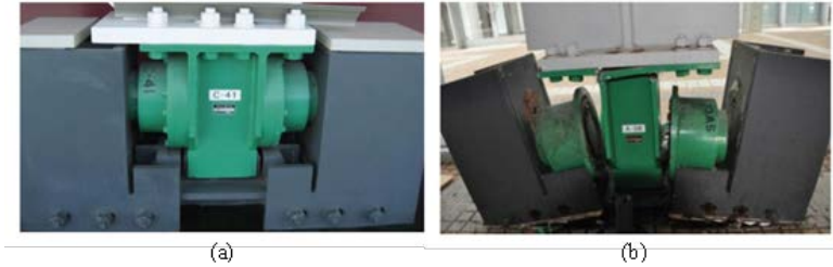
Şekil 9. Doğu Japonya Depreminde Hasar Gören Sıvı Viskoz Sönmleyici; (a) Sağlam Sönmleyici; (b) Hasarlı Sönmleyici
