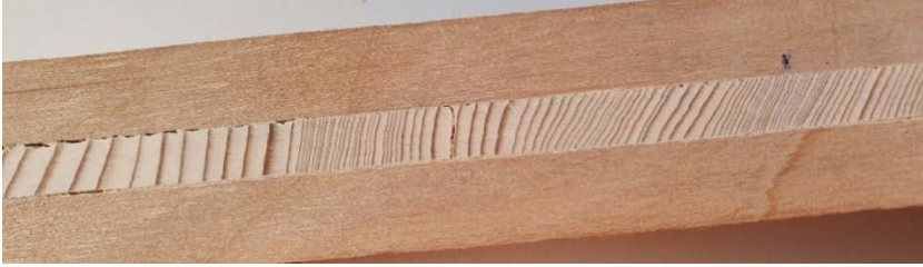
Fotoğraf 3. Zımparalama işlemi sonrasında yıllık halka sınırları belirgin hale getirilen bir örnek
