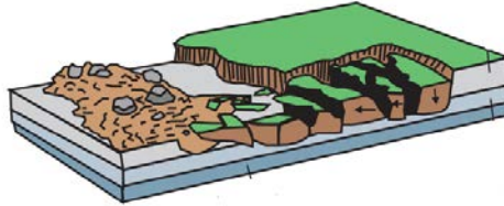
Şekil 9. Yanal yayılma türünün gösterimi (Cruden, 2014)
