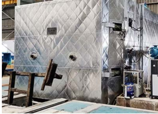
řekil 11. Vakumlayarak Kurutma İřlemi İin Kullanılan Vakum Odası
