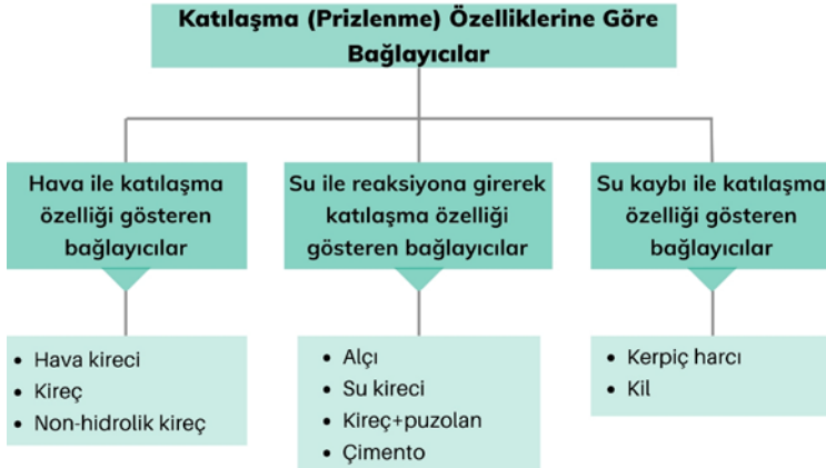
Şekil 4. Katılma özelliklerine göre bağlayıcı malzemeler (Artel & Dibağ, 1969; Ashurst & Ashurst, 1988; Borelli, 1999; Güleç, 1992; Kozlu, 2010; Torraca, 1982)
