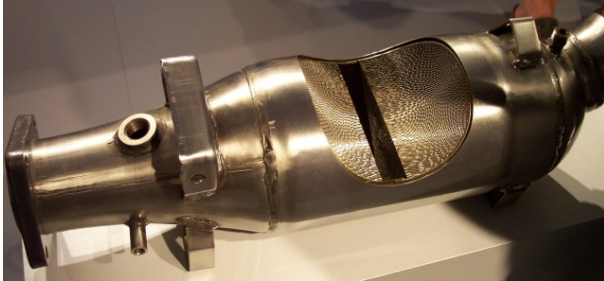
Resim 3 Metal taşıyıcılı katalitik dönüştürücü kesiti
