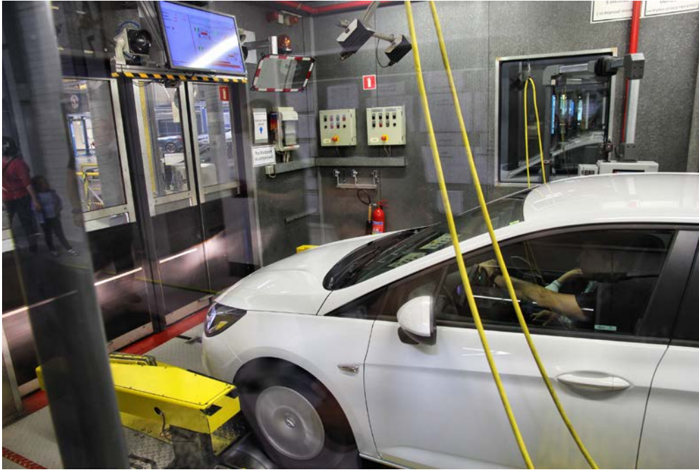
Resim 14 Şasi dinamometresinde taşıt deneyi
