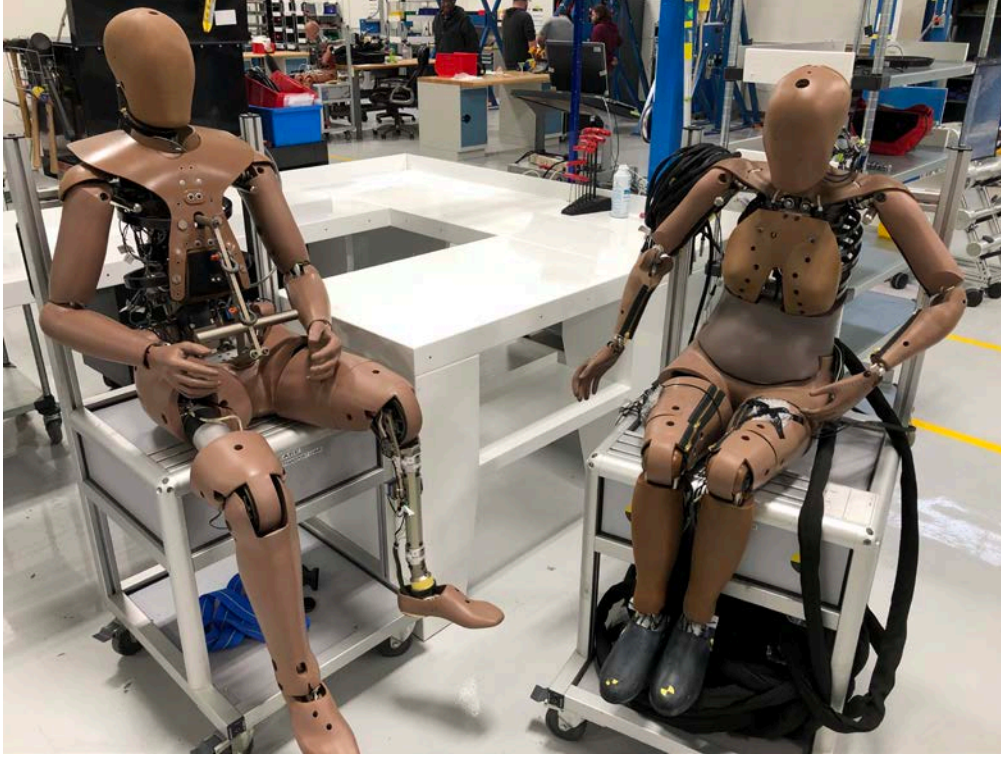
Resim 13 Çarpışma deneyinde kullanılan ölçüm mankenleri
