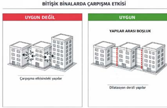
Şekil 11. Bitişik Binalarda Çarpışma Etkisi (Çekiçleme Etkisi)
