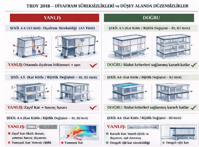
Şekil 7-2. Diyafram Süreksizlikleri ve Düşey Alanda Düzensizlikler
