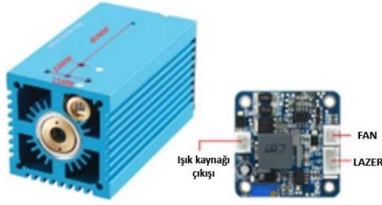
Şekil 13. Sistemde Kullanılan Lazer Modülün Teknik Özellikleri
