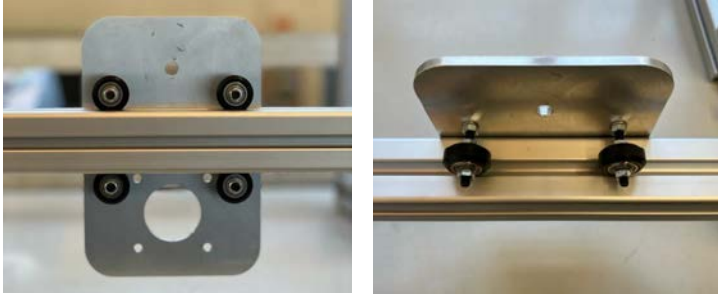
Şekil 9. Plakaların Profile Bağlanması
