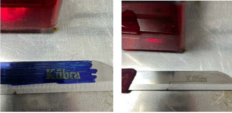
Şekil 17. Deneysel Olarak Gerçekleştirilen Markalama İşlemi
