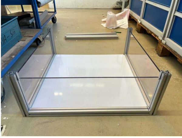
Şekil 6. Polycarbon Plakaların Montajlanması
