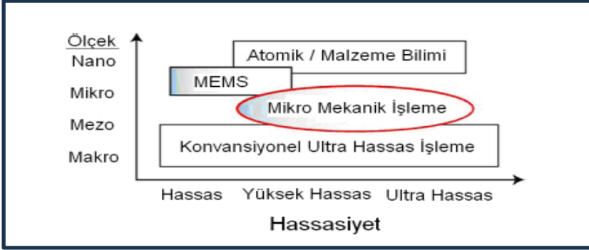
Şekil 1: Mikroişlemenin çalışma boyutları (Serje, David, Jovanny Pacheco, & Eduardo Diez, 2020).
