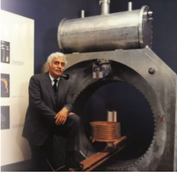
Şekil 1. Dr. Raymond Damadian ve geliştirdiği dünyanın ilk tam vücut manyetik rezonans tarayıcısı "Indomitable" (1977) [2].
