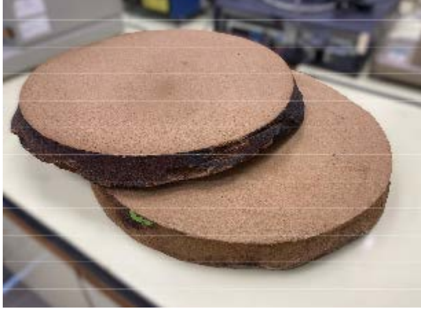
Ş ekil 4. Yalıtım levha numuneleri (üstteki levha yalanca akasya, alttaki levha ise ıhlamur ağ acı kabu ğu liflerinden ü retilmiştir) (Mialeshka et al., 2025).
