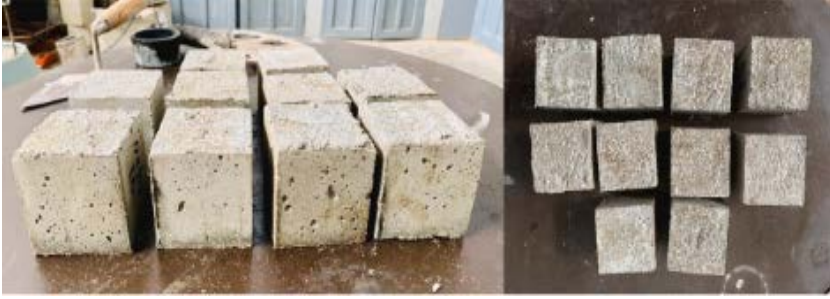
Şekil 8. Biyo katkılı harç örnekleri (Srikanth et al., 2022).
