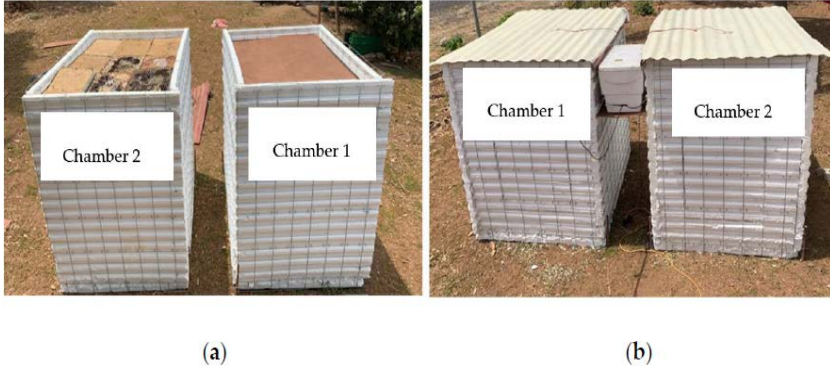
Şekil 7. Test odaları: Pirinç kabuğu yalıtkan olmayan 1. oda ve pirinç kabuğu yalıtkan olan 2. oda. (a) Galvanizli çatısı olmayan odalar ve (b) galvanizli çatısı olan odalar.
