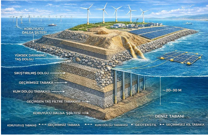
Şekil 4. Yapay ada kesiti, dolgu katmanları ve temel sistemini gösteren teknik diyagram.
