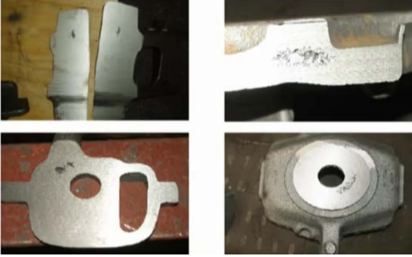
Şekil 3. Döküm Parçaların Hurdaya Ayrılmasına Sebep Olan Çekinti Hatalarına Örnekler [17].
