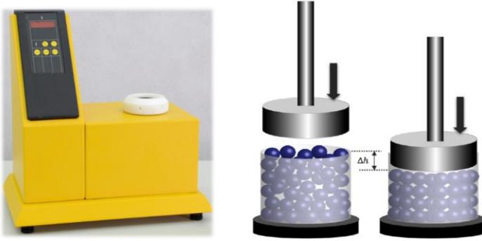
Şekil 6. Sıkıştırılabilirlik test cihazı (solda) ve sıkıştırma işleminin (sağda) gösterimi
