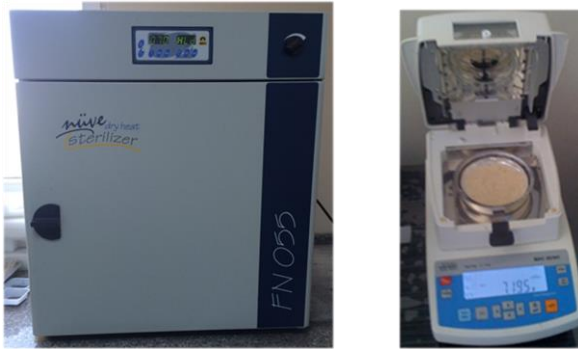
Şekil 7. Rutubet ölçümünde kullanılan etüv (solda) ve dijital rutubet ölçüm cihazı (sağda)
