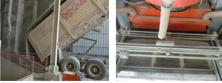
Şekil 3. Seramik karo granüllerinin kamyonla beşiğere dökülmesinin (solda) ve pres arkasına beslenmesinin (sağda) gösterimi
