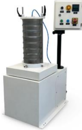
Şekil 9. Tane boyut dağılımının belirlenmesinde kullanılan elek seti ve cihazının gösterimi
