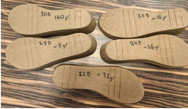
Şekil 2. Esnek poliüretan kullanılarak üretilen farklı yoğunluklu ayakkabı tabanları
