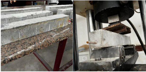
Şekil 5. Beton eğilme numuneleri ve deneyin yapılışı
