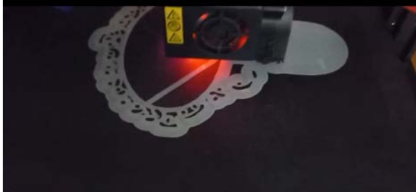
Görsel 7. 3D yazıcı yolculuk eseri baskı süreci ilk katman görüntüsü
