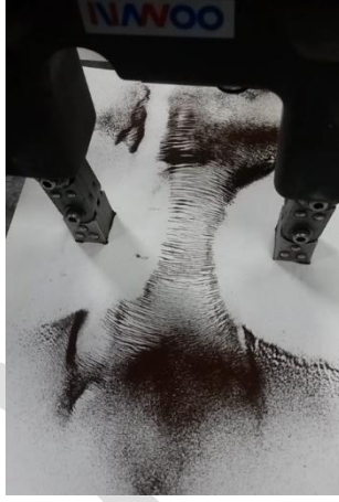
Şekil 5. Manyetik yoke ayakları arasına serpilmiş manyetik paracıkların manyetik alan çizgileri üzerinde yönlenmeleri
