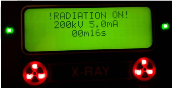
Şekil 11. Xray cihazında 200Kv 5mA değrinde 16 saniye olarak yapılan pozlamanın kontrol ekranında görüntüsü.
