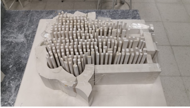
Şekil 3. 270 Adet Alçı Parça ile Hazırlanmış Kalıp Kurgusu
