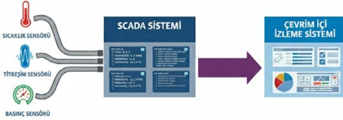
Şekil 1. Veri toplama ve gönderme aşamaları
