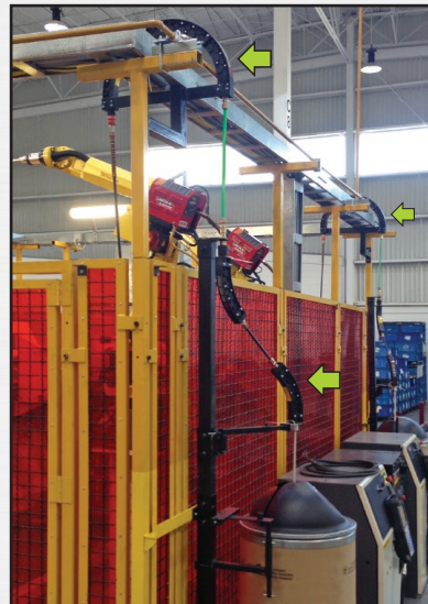
180° 模块安装在带有两个机器人 & Non-Stop™ 送丝系统
