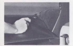
7. INSTALL THE REAR DRAIN TROUGH TRIM COVER
