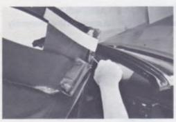
7. REMOVE SIDE RETENTION CABLE FROM FRONT SIDE RAIL
