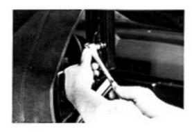
6. INSTALL FRONT RAIL WEATHERSTRIP AND FRONT RAIL WEATHERSTRIP RETAINER ASSEMBLIES
