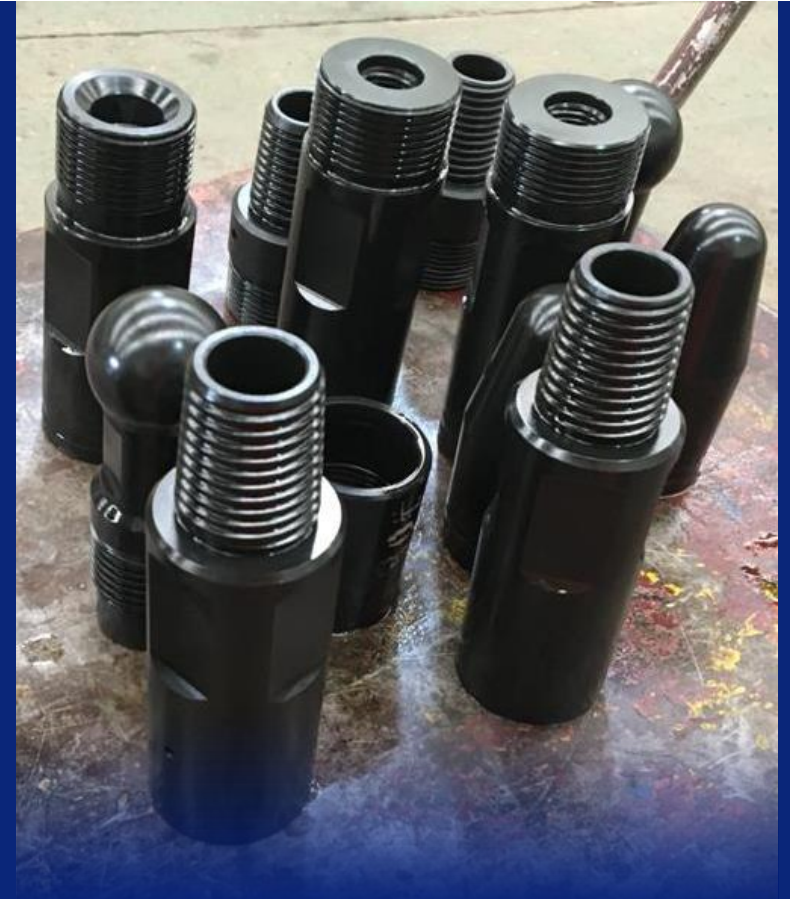
Fabricación de herramienta porta-sondas articulada para operaciones de pozo
