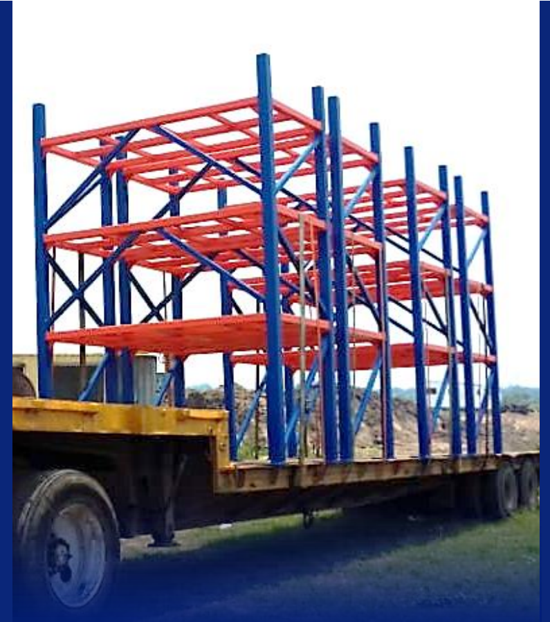
Fabricación de rack de almacenado de barrenas para 7.5 toneladas por modulo
