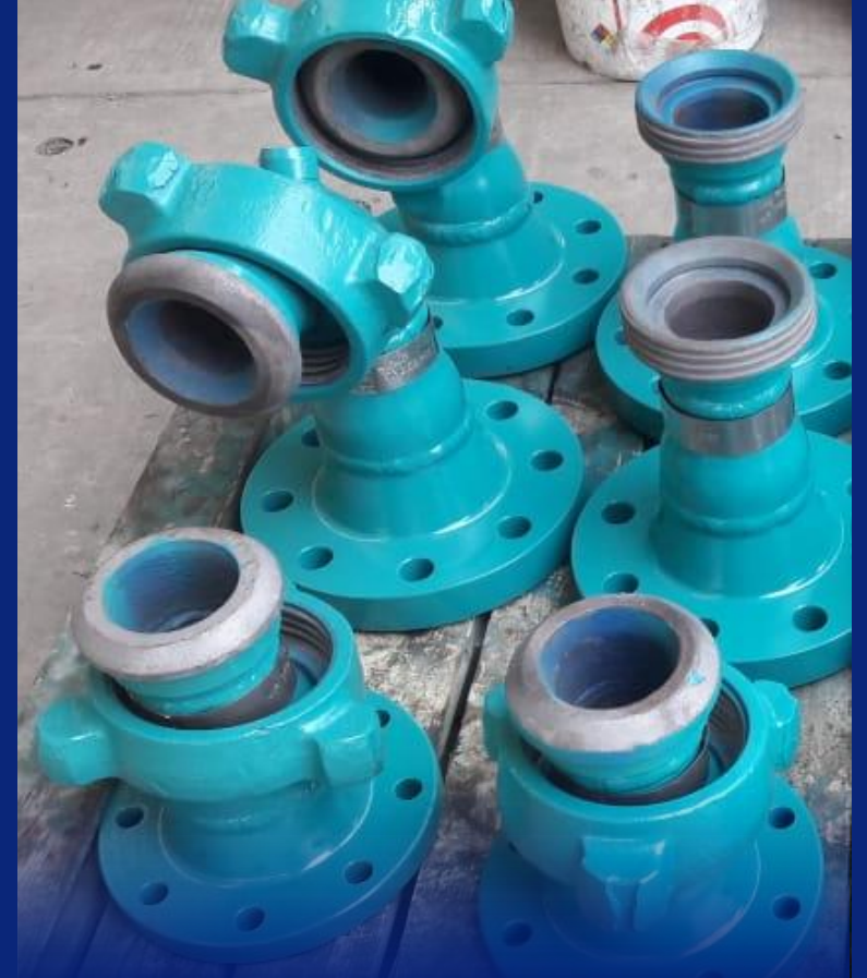
Acabado final con tratamiento anticorrosivo de acuerdo con especificaciones del cliente.
