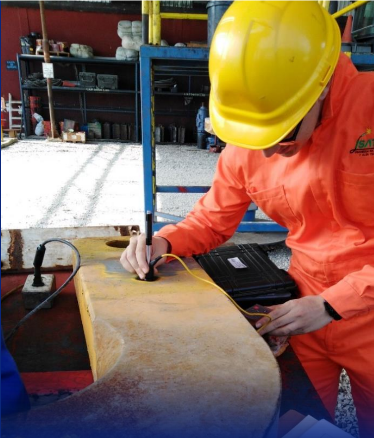
Determinación de propiedades mecánicas de material en campo
