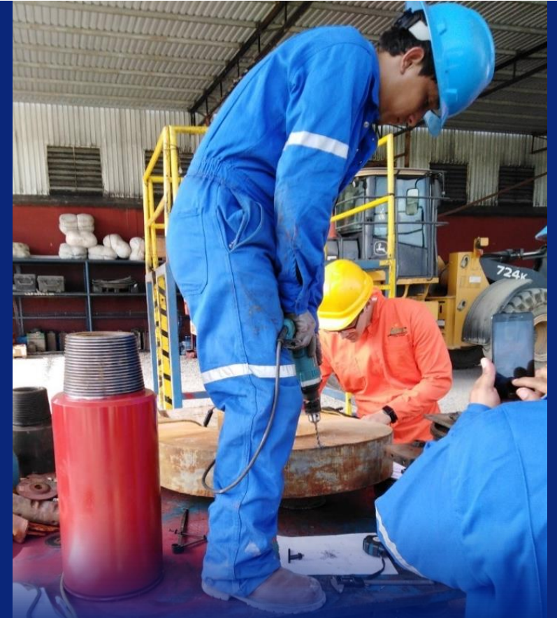
Recolección de muestras de material en campo para estudio químico metalográfico.
