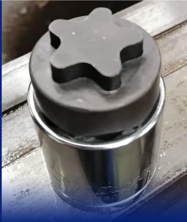
Fabricación de dado especial para candado anti-robo
