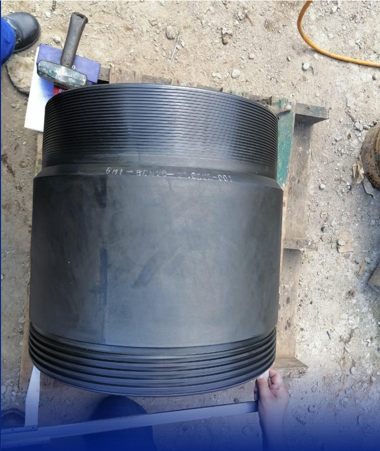
Maquinado de combinación 20BCN A 20 ACME
